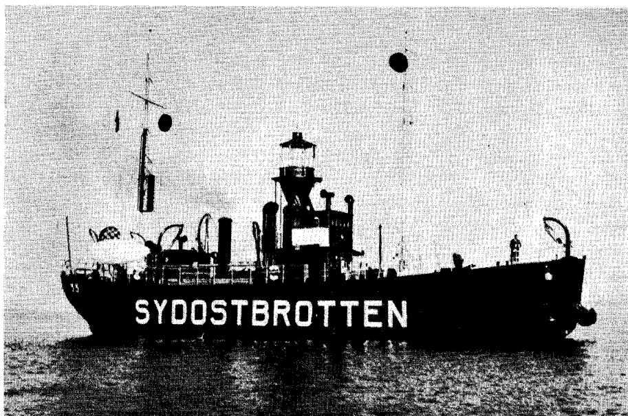
Sveriges yngsta fyrskepp, levererat år 1934, har ett displacement av 360 ton, en längd av 34.4 m samt eget framdrivningsmaskineri (råoljemotor) med en effekt av 400 hk. Ombord finnes elektrisk, råoljedriven kraftcentral med ackumulatorbatteri, elektriskt fyrljus, nautofonanläggning, radiofyr och radiotelefon. Bemanningen uppgår till 8 man.
