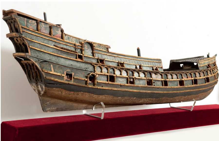
Figur 6. Votivskeppet från Storkyrkan i Stockholm dateras till tiden omkring sekelskiftet 1600. Notera hur de aktersta kanonportarna bryter igenom de förgyllda längsgående berghulten (SMTM, ID 169).
